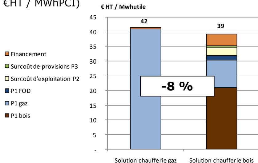
Exemple du séchage artificiel (Volume annuel séché de 15 000 à 20 000 m<sup>3</sup>, 90% résineux - besoins annuels de 5 300 Mwhutiles – Capacité séchoirs : 700 m<sup>3</sup> – prix du bois : 12 €HT/MWhPCI, prix du gaz : 35 €HT / MWhPCI)
