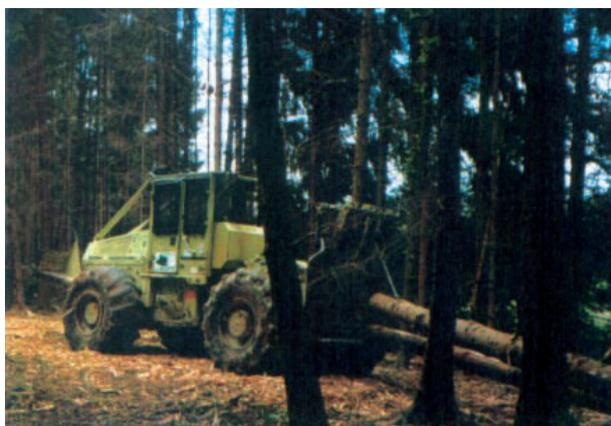
Photo 9 : Débardage par treuillage au débuseur
