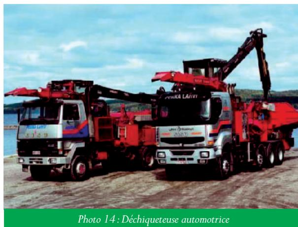
Photo 14 : Déchiqeteuse automotrice
