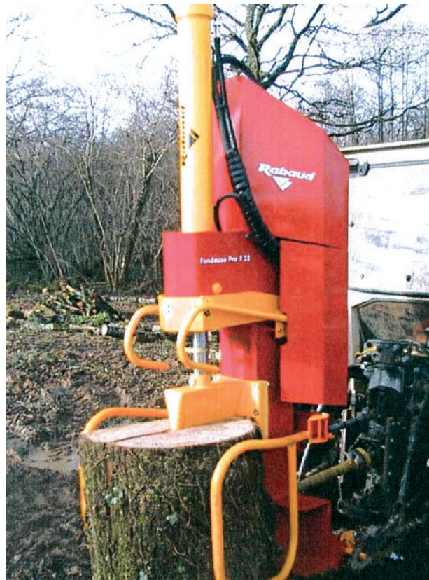
Photo 18 : Fendeuse verticale avec treuil de levage (Rabaud)
