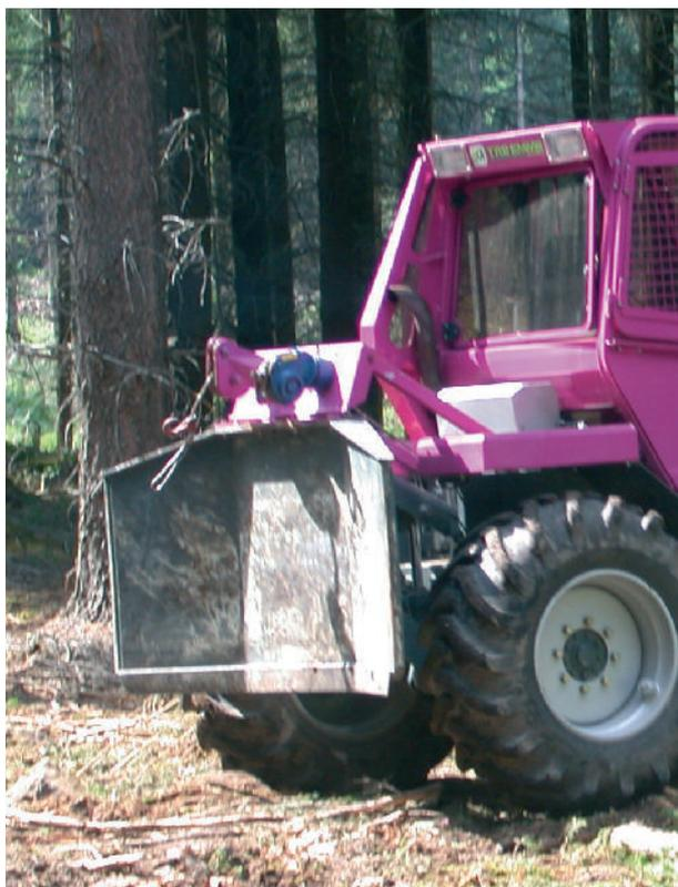
Photo 8 : Treuil de débardage monté sur tracteur agricole
