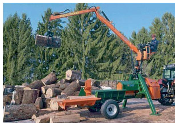
Photo 19 : Fendeuse horizontale avec grue (POSCH)
