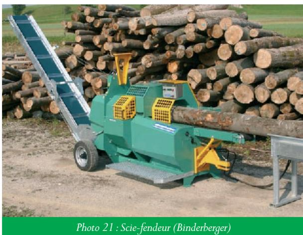
Photo 21 : Scie-fendeur (Binderberger)
