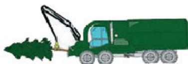
2. Déchiquetage sur coupe avec une automotrice équipée d'une benne élévatrice
