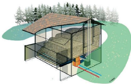
Schéma 34 : Chaufferie et stockage d'un réseau de chaleur
