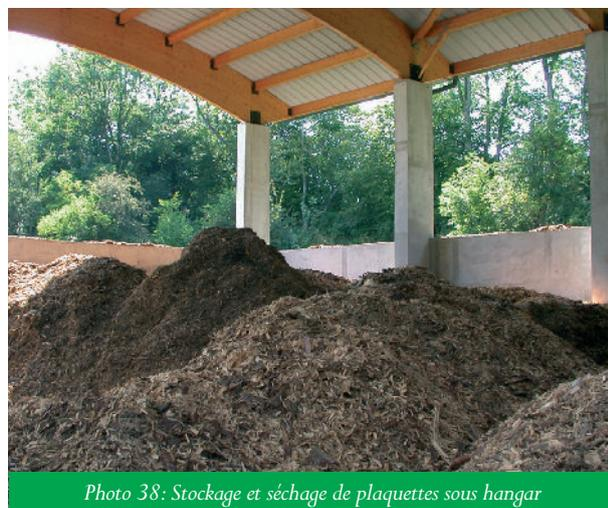
Photo 38: Stockage et séchage de plaquettes sous hangar
