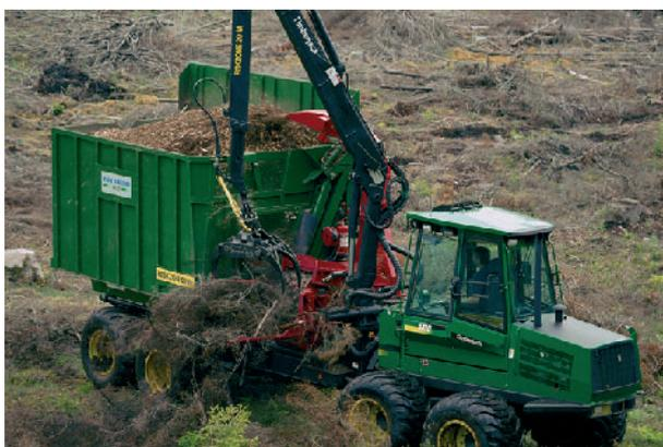
Photo 13 : Déchiqeteuse automotrice
