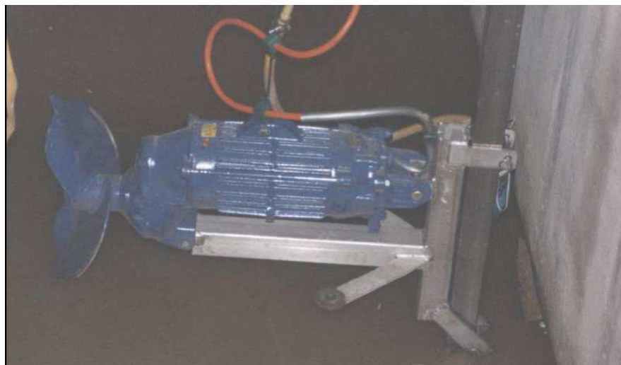
Fig.27. Mélangeur à moteur électrique plongé dans le substrat.
