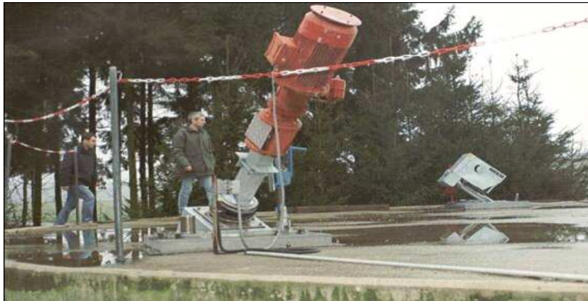
Fig.26. Mélangeur à moteur monté à l'extérieur, dite perche
