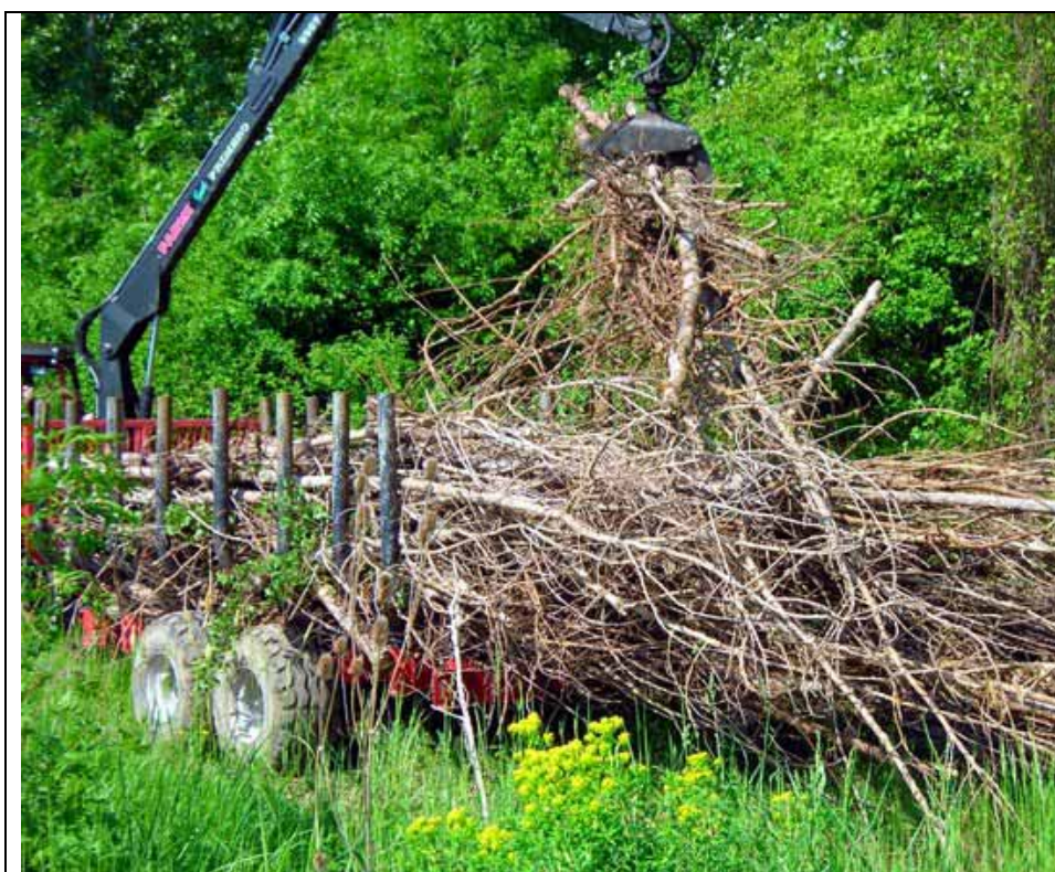
Le foisonnement des cimes de peuplier conduit à sous charger l'engin de débardage.
