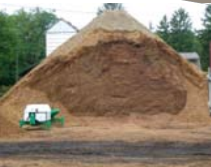
Exemple de stockage à l'air libre. Le tas de plaquettes compacté permet un séchage naturel sans reprise d'humidité.
