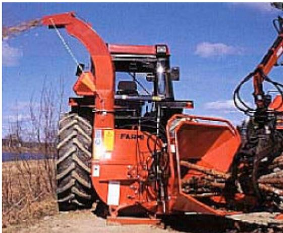
**Photo 1 :** déchiqueteuse à disque avec prise de force par tracteur
