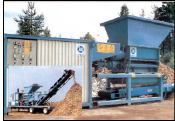
**Photo 3 :** Broyeur à vis casseur
