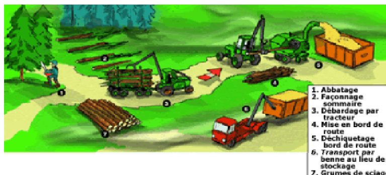
Figure 3 : Les différentes étapes de l'approvisionnement en plaquettes forestières
