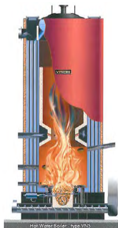
Figure 13 : Chaudière à poussée inférieure à tubes d'eau (Source : Vyncke)
