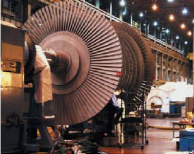
Le principe général consiste à utiliser de la vapeur haute pression, entre 40 et 50 bars et 400 à 500°C, produite au niveau de la chaudière pour entraîner la turbine. La vapeur est détendue dans une turbine couplée à un alternateur qui assure la production électrique. La vapeur est par la suite condensée en cédant sa chaleur à une source froide – l'eau du réseau de chaleur - puis renvoyée dans la chaudière par l'intermédiaire d'une pompe.
