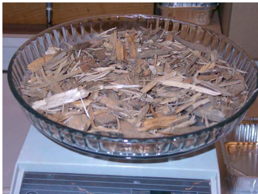
Pesée de l'échantillon de plaquettes forestières
