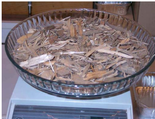
Pesée de l'échantillon de plaquettes forestières
