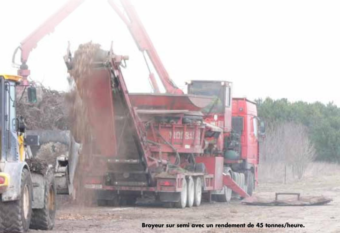
**Broyeur sur semi avec un rendement de 45 tonnes/heure.**
