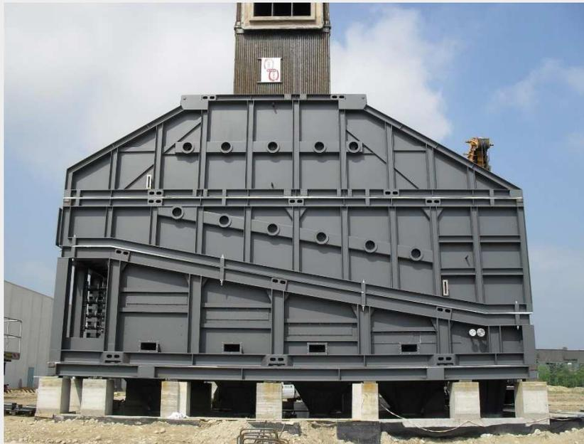
Chaudière vapeur à tubes d'eau de 14 MW
