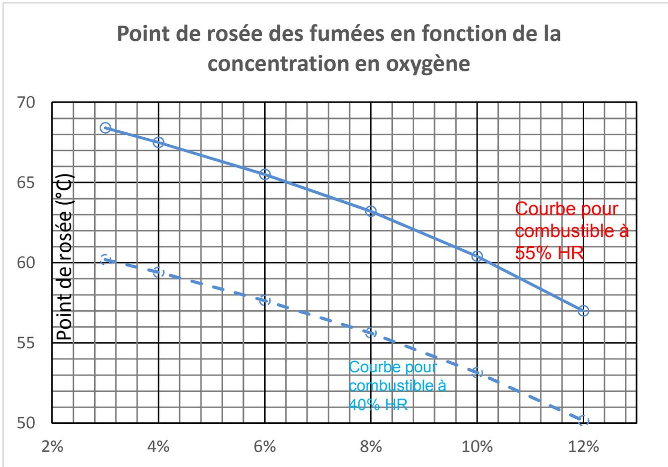
Évolution de la température du point de rosée en fonction du taux d'oxygène dans les fumées
