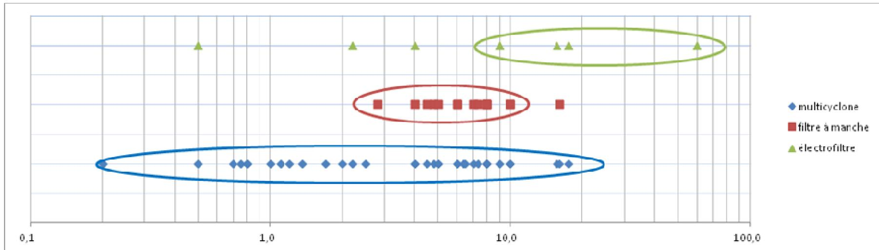
*Systèmes de dépoussiérage en fonction de la puissance bois (MW) des installations*
