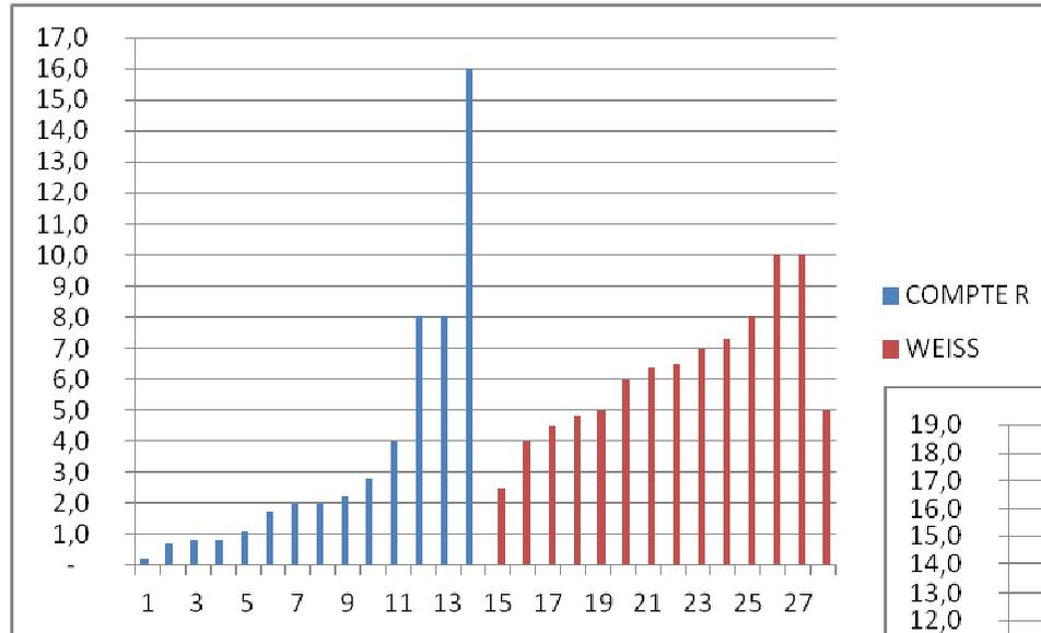
*Puissances des chaudières (MW) par constructeur (sur un échantillon de 35 installations)*
