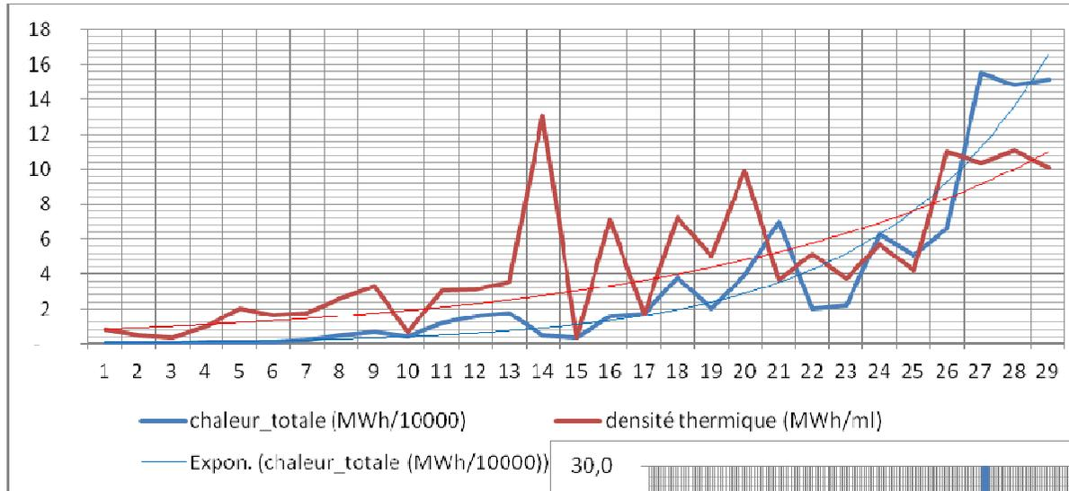
*Longueur des réseaux et densité thermique sur 29 réseaux classés par puissance totale croissante (totalisant 169 Km pour 5,66 MWh/ml en moyenne)*
