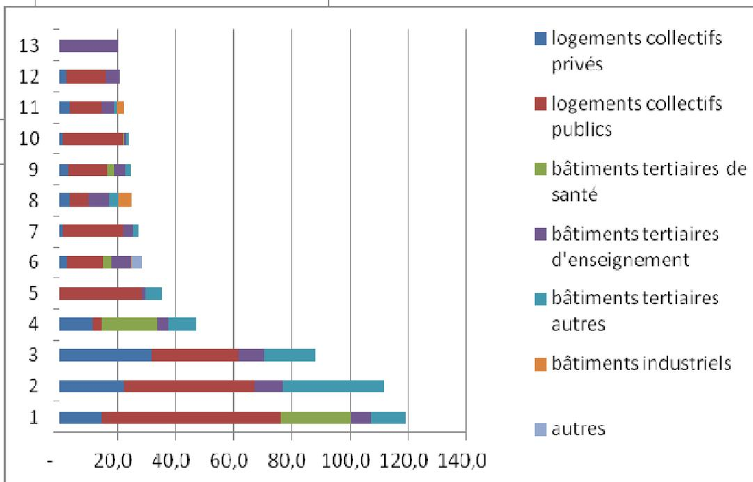
Répartition de l'énergie livrée pour 13 réseaux bois de 20 MW à 120 MW >>
