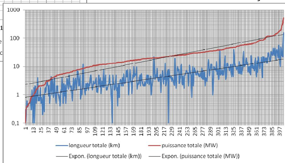
On notera une tendance à l'augmentation du ratio puissance installée / longueur de réseaux avec l'augmentation de la première, sans doute à mettre en lien avec le caractère plus marqué de multi-énergies des grands réseaux.
