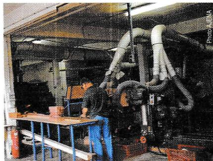
Système d'aspiration sur une machine à bois
