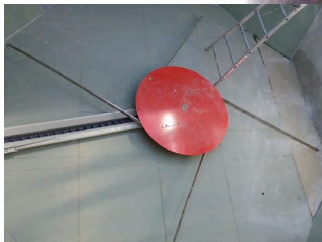
Dessileur à bras rotatifs et vis sans fin
