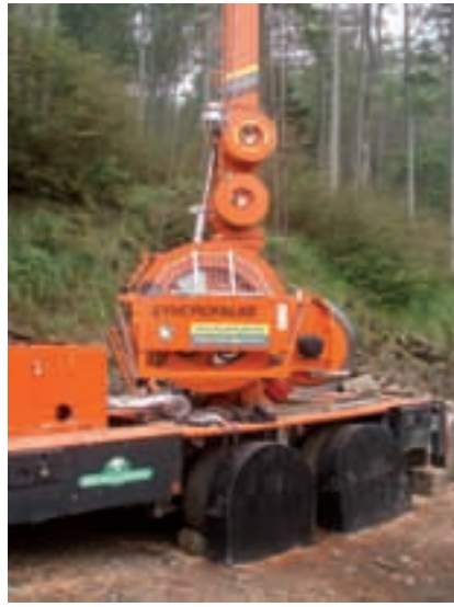
Câble mâât ONF sur remorque dans les Pyrénées
