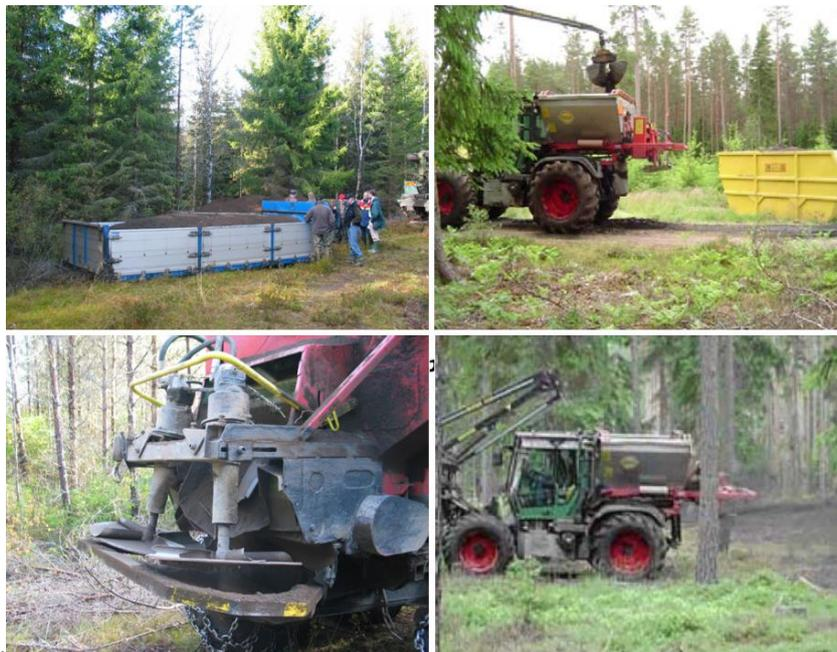
L'épandeur est un caisson d'épandage monté sur un débardeur forestier, solidaire du tracteur ou articulé.
