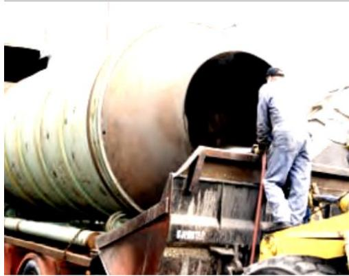
Figure 1: Humidification de cendre de bois à l'aide d'une bétonnière, source : ReCash
