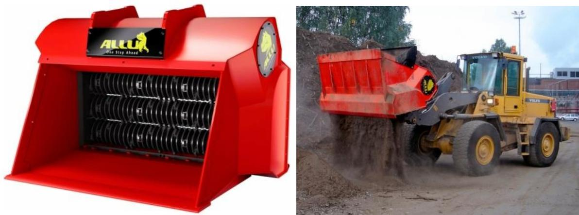
Figure 3 : godet de criblage pour le concassage des cendres auto durcies
