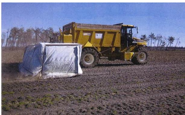
Figure 7 : Automoteur pour épandage de chaux, matériel utilisé par SAS TEMBEC pour ces essais expérimentaux (2011)
