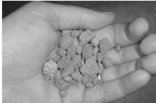
Figure 4: granules de cendre obtenue par auto durcissement, source SLU
