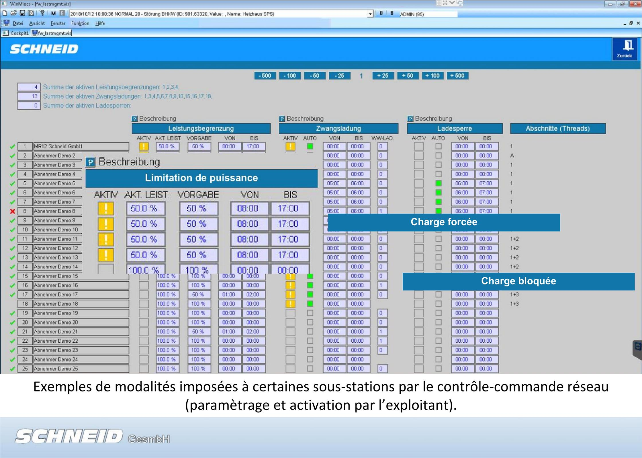
Exemples de modalités imposées à certaines sous-stations par le contrôle-commande réseau (paramétrage et activation par l'exploitant).
