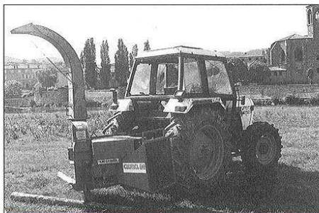
Une déchiqueteuse, de moyenne capacité, à alimentation latérale, portée sur 3 points d'un tracteur agricole et entraînée par sa prise de force
