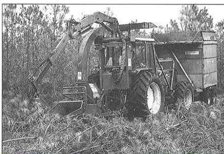
Un ensemble de type agricole constitué d'un tracteur avec grue, d'une déchiqueteuse à alimentation frontale et d'une remorque élévatrice
