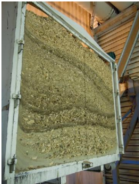
Exemple de stratification granulométrique (fines et poussières) inhérente au transport de plaquettes → le multi échantillonnage reste ainsi la meilleure « chance » d'avoir une vision représentative d'une livraison (photo JMB - 2018)
