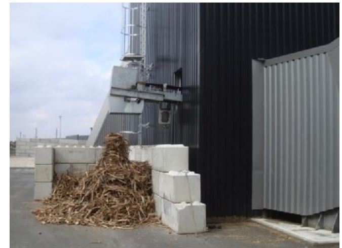
Même site, biomasse rejetée par le cribleur à étoile intégrée au convoyage biomasse (photo JMB - 2014)
