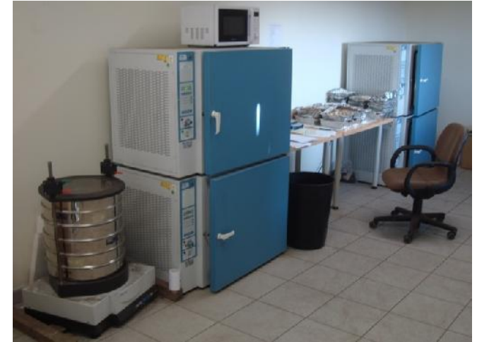
Exemple local dédié contrôle biomasse livrée sur une cogénération 25 MW PCI & 7,5 MWé (photo JMB - 2014)
