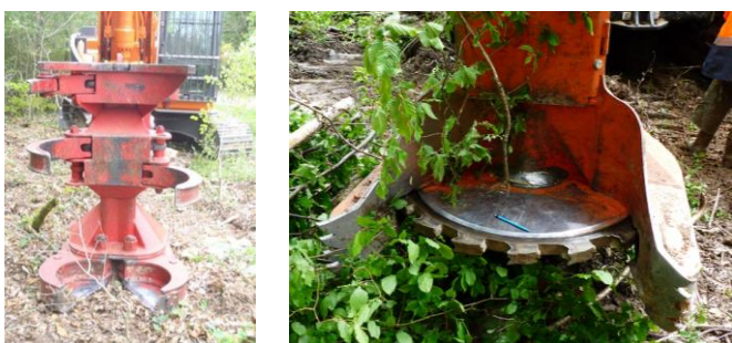
Figure 5 : Tête à cisaille et tête à disque
