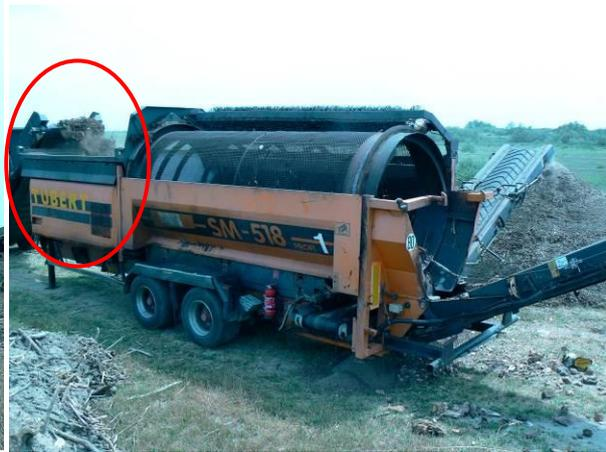
Photo 37 : Passage du broyat d'un broyeur lent à la cribleuse, (EID Méditerranée, 2013)
