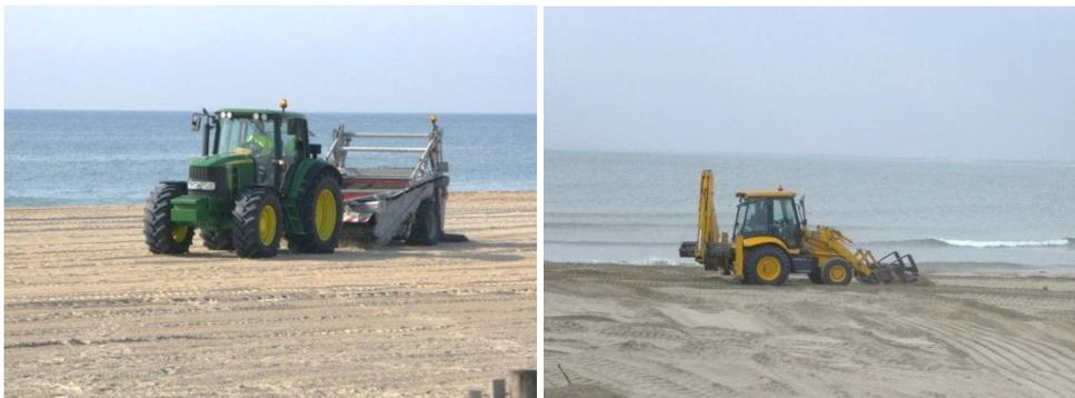
Photo 24 : Nettoyage mécanique sur des plages du Languedoc-Roussillon, (EID Méditerranée, 2014)
