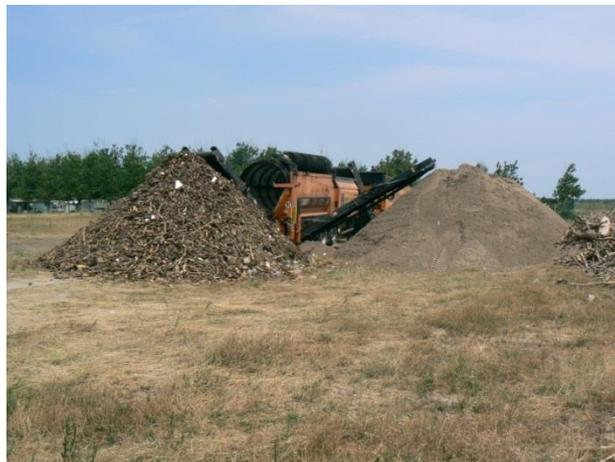
Photo 39 : Tas de sable et de broyats obtenus après le premier broyage et le criblage
