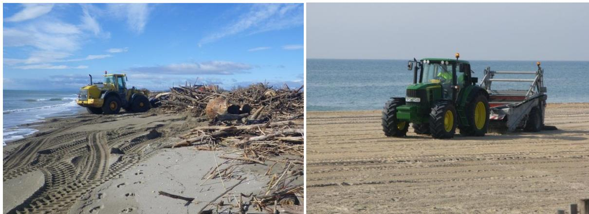
Photo 8 : Opération de nettoyage de plage mécanique, (EID Méditerranée)
