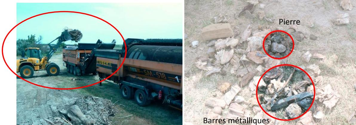
Photo 36 : Pré broyage avec un broyeur lent et refus de broyage (EID Méditerranée, 2013)
