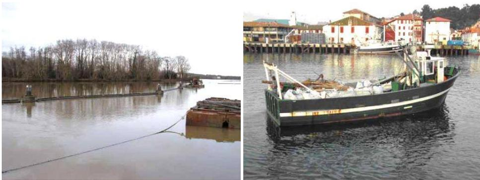
Photo 23 : Barrage flottant sur l'Adour (à gauche) et bateau de ramassage des déchets du Syndicat Mixte Kosta Garbia, (Site de l'Observatoire de la côte Aquitaine, 2014)
