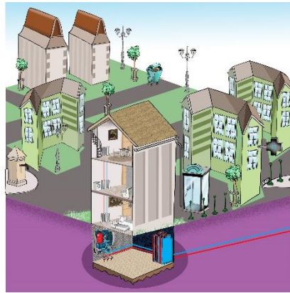
Figure 25 : Représentation d'une sous-station (source : Via Sèva)
