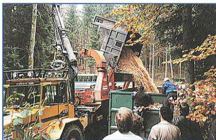
En Suisse : la grosse machine de Thermobois sur porteur Volvo, déversant son chargement dans un conteneur
