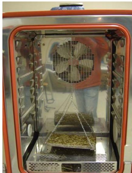
*Figure 65 : Dispositif expérimental de séchage en enceinte climatique.*
