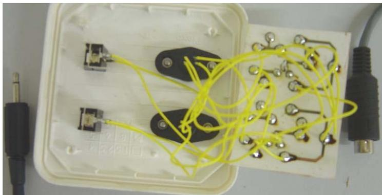
Figure 24 : Module contenant 2 ponts de Wheatstone
