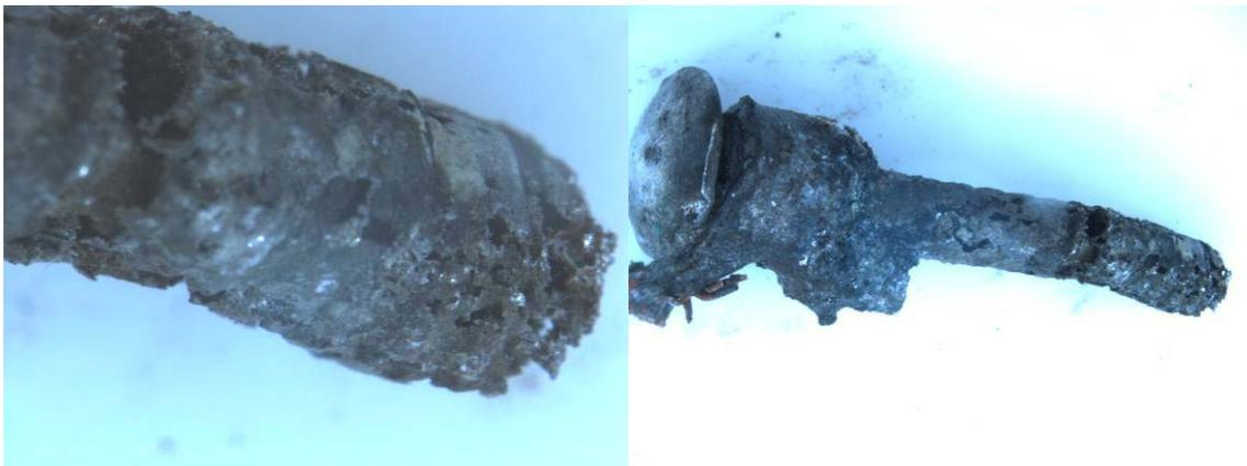
*Figure 57 : Pointe inox dégradée suite à l'essai*
