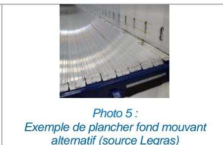
Photo 5 : Exemple de plancher fond mouvant alternatif (source Legras)
