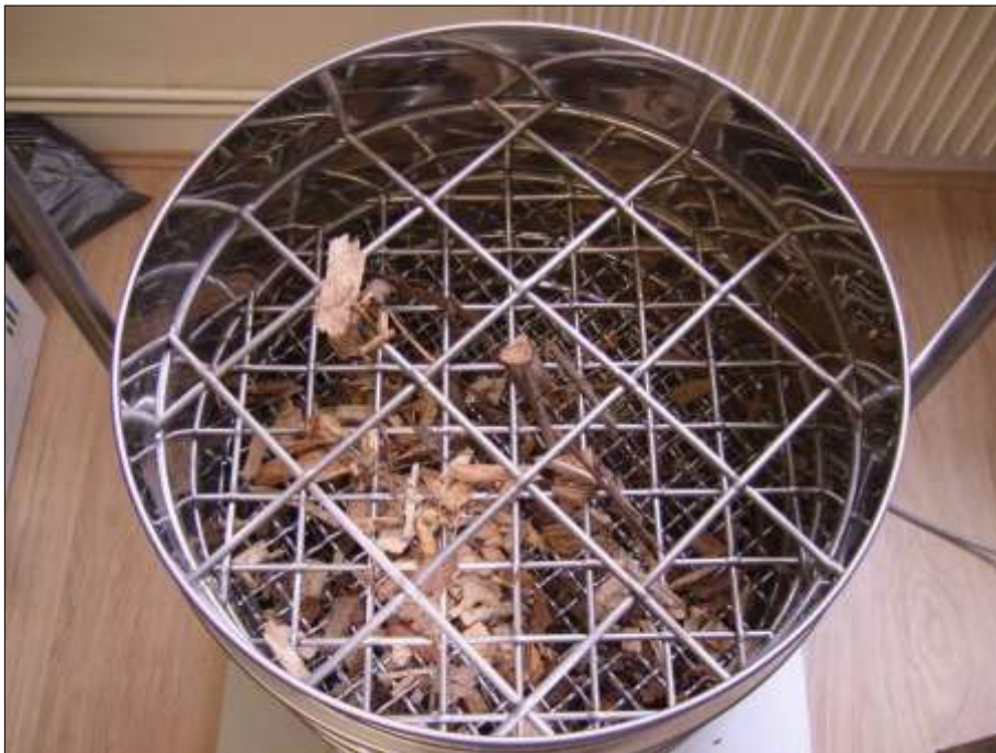
Figure 27 : Photo des plaquettes réparties après tamisage Vue du dessus du tamis mécanique après ouverture du couvercle
