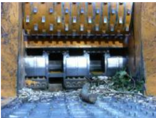
Figure 32 : Détails de la déchiqueteuse Valormax D 42-100 de la CUMA Innov'61 : le rotor et les couteaux
