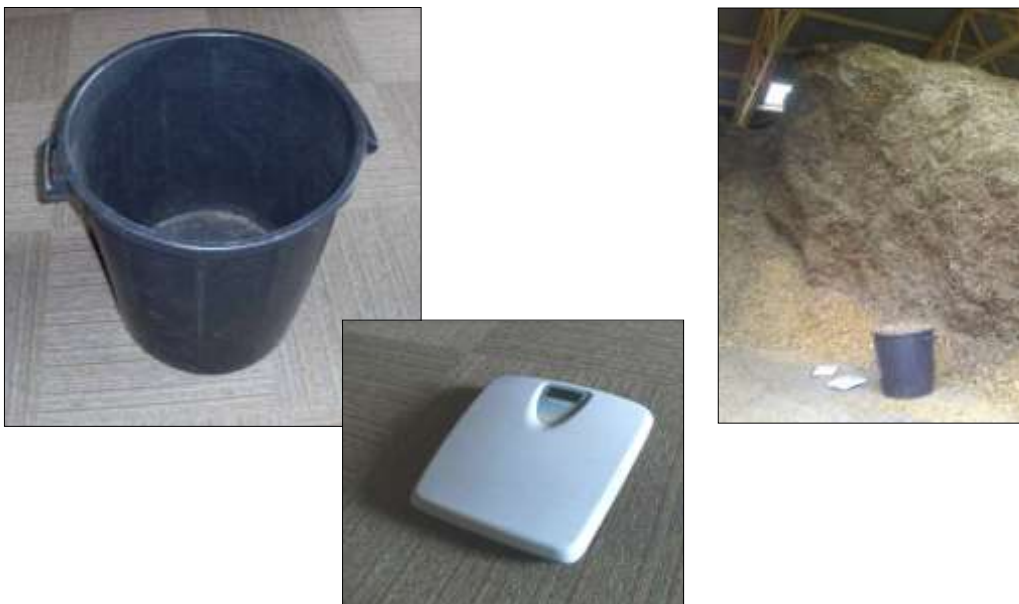
Figure 30 : Photo du matériel utilisé pour mesurer la masse volumique des plaquettes
