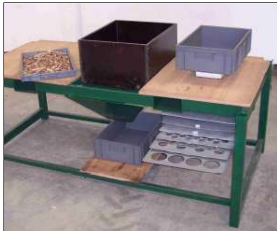
Figure 6 : Tamis de plaquettes mis au point par la station des Cormiers (35)
