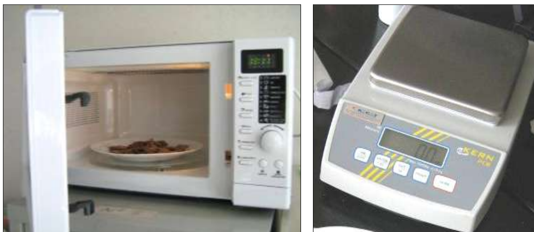
Figure 19 : Photo du matériel utilisé pour la mesure du taux d'humidité au micro-ondes
