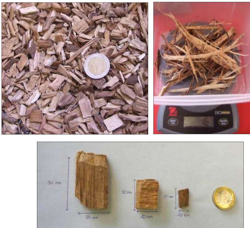
Figure 28 : Photos de plaquettes bien calibrées visuellement (avec pièce de 2 €) à gauche, de bois défibré en cours de mesure à droite, de morceaux de bois-décheté mesurés à la règle en bas (et pièce de 1 €).
