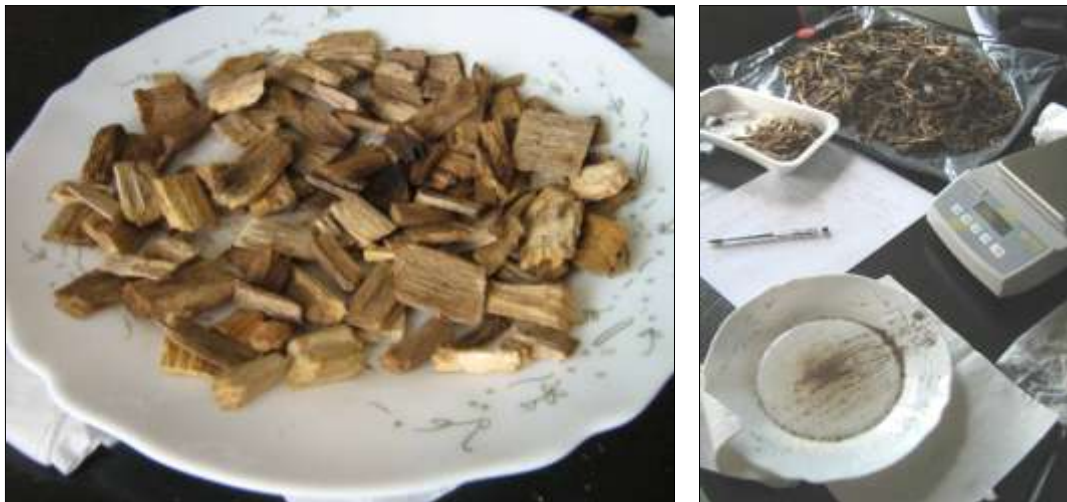
Figure 20 : Photos prise au cours de mesure de l'humidité des plaquettes avec la méthode du four à micro-ondes
