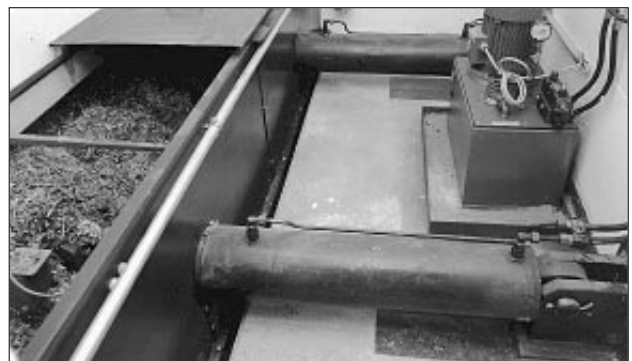
Cylindre hydraulique pour systèmes à poussoirs de fond et convoyeur transversal
