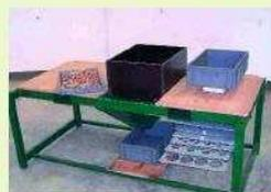
Le banc de caractérisation de la granulométrie des plaquettes mis au point à la station des Cormiers.
