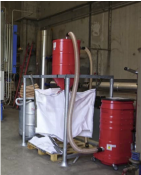
Figure 3-5: Aspiration vers un big-bag (source Philtec système)
