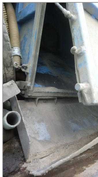
Position ouverte de la paroi arrière (dépotage sur l'aire de valorisation)
