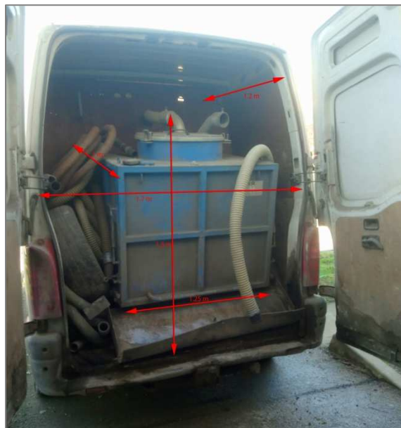
Vue d'ensemble et côtes de la benne à cendres
