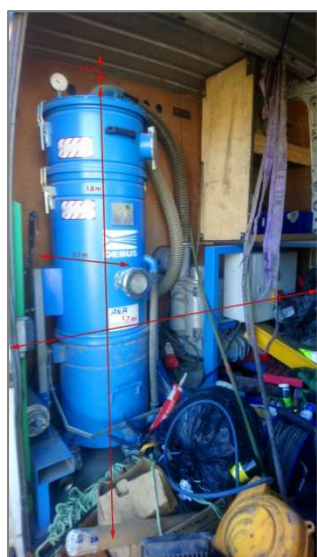
Filtre à manche avec bac de stockage inférieur escamotable
