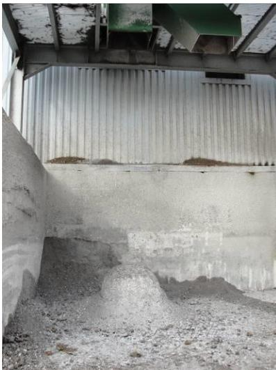
Stockage tampon (big-bag) de cendres volantes sur le site d'une installation de cogénération avec four à grille. Photo CEDEN
