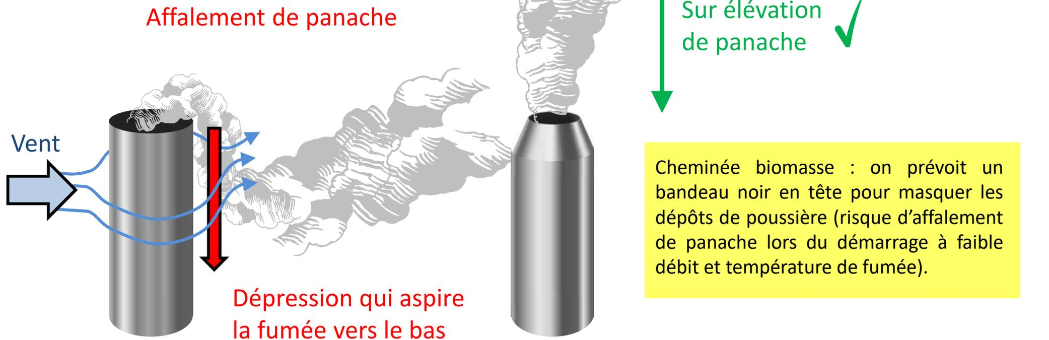
Le cône d'éjection peut permettre d'accélérer les fumées pour respecter la législation et limiter les affalements de panache.
