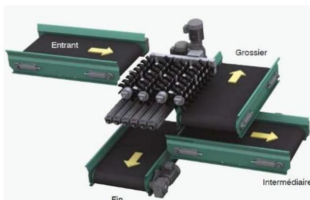
Figure 11 : Schéma de fonctionnement du crible étoile KOMPTECH Multistar L3
