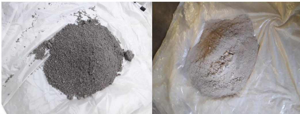
Photo 3 : Exemple d'échantillon de cendres sous-foyer (à gauche) et de cendres multicycloniques (à droite)
