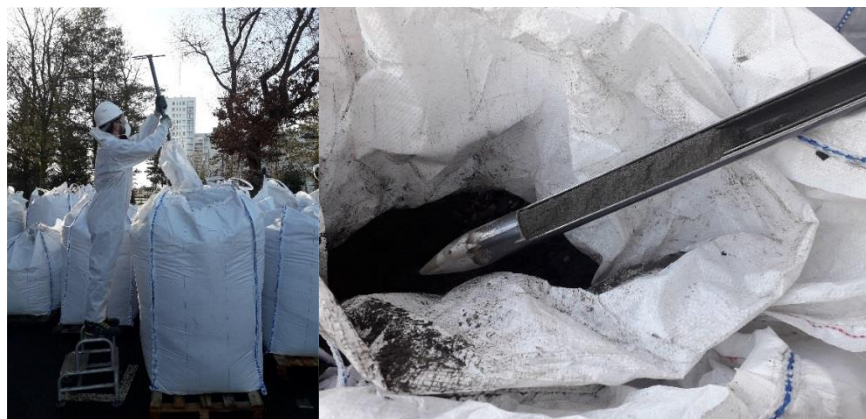
Photo 2 : Matériel d'échantillonnage : canne de prélèvement
