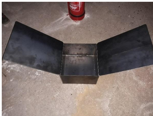
Photo 4 : Bac en acier avec déflecteurs
