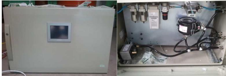
Figure 34 - Unité de régulation équipant les sondes de dilution à chambre biconique
