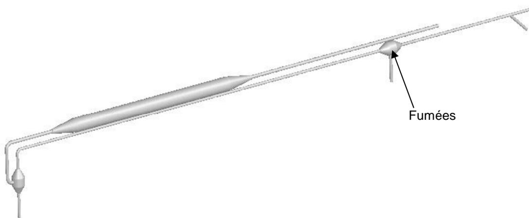
Figure 17 - Schéma de principe du diluteur avec 2 chambres biconiques
