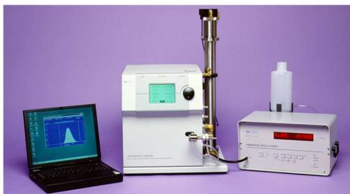
Figure 23 - Analyseur de mobilité électrique à balayage SMPS
