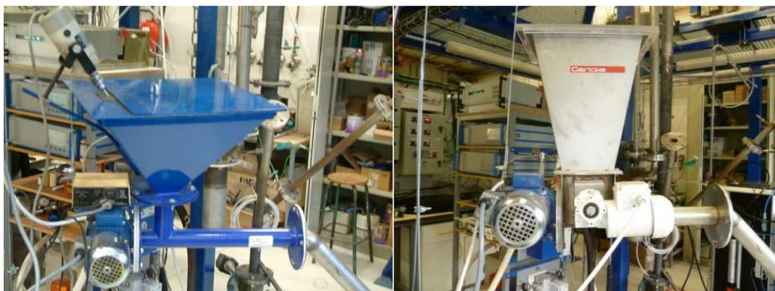
Figure 70 - Vues du doseur volumétrique avant (à gauche) et après (à droite) modifications
