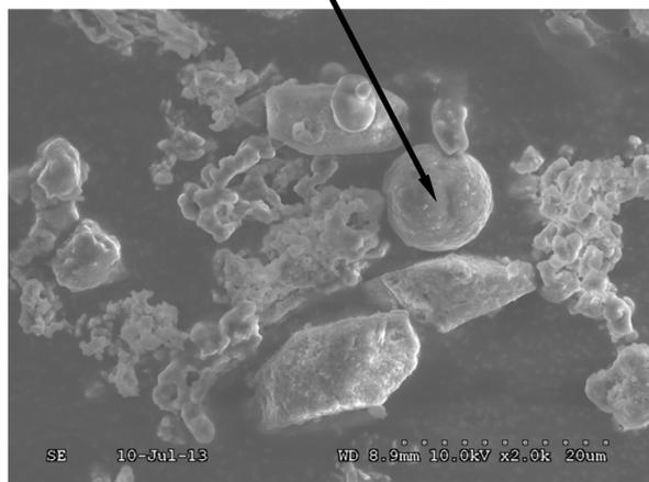
Figure 152 - Images MEB (détecteurs d'électrons secondaires) de particules de cendres volantes, typiquement observées pour les échantillons collectés dans le cyclone secondaire pour les essais réalisés en mode busette pour les trois combustibles (Essais 1, 2 et 3)
