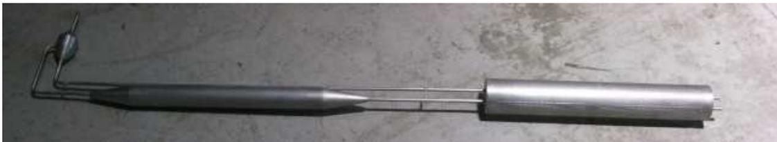
Figure 16 - Diluteur avec chambre biconique
