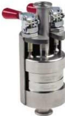
Figure 117 - Impacteur manuel à trois étages utilisé pour la collecte des particules sur filtres
