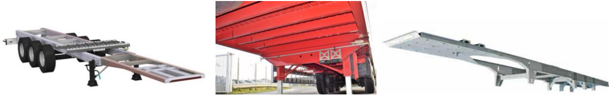
Figure 2 : Exemple de châssis : Benalu Jumbotrack à gauche, Jumboliner au centre et Legras continu à droite (source : sites Internet des entreprises)
