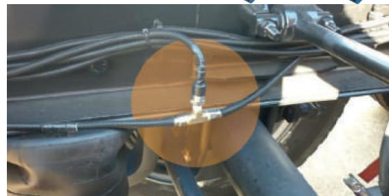
Figure 16 : Capteur mécanique (gauche) et capteurs pneumatiques utilisés (Source VEI)
