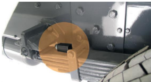
Figure 16 : Capteur mécanique (gauche) et capteurs pneumatiques utilisés (Source VEI)
