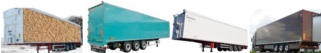
Figure 3 : Exemple de fond mouvant : Socari allégé 90m 3 , Legras FMA routière, Benalu Jumbotrack, Berroyer muti transport (source : sites Internet des entreprises)
