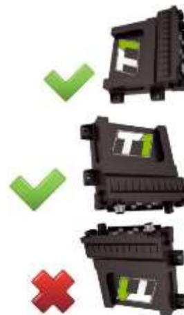
Figure 2 : sens d'orientation des boîtiers
