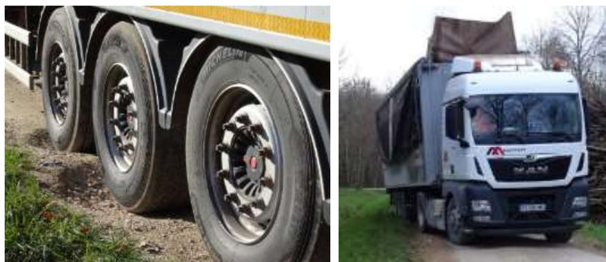
Images 17 et 18 : deux conditions défavorables pour une mesure de qualité : gauche – roues de la remorque dans des trous ; droite – ensemble de travers et arrière de la remorque dans le talus
