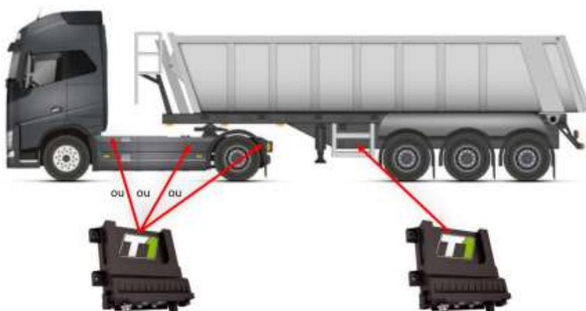
Figure 1 : positions d'installation des boîtiers sur l'ensemble tracteur-remorque
