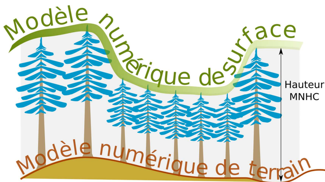
Figure 5 : la différence entre le modèle numérique de surface obtenu par corrélation d'images et le modèle numérique de terrain permet d'obtenir le modèle numérique de hauteur de canopée (MNHC) qui décrit la hauteur des arbres
