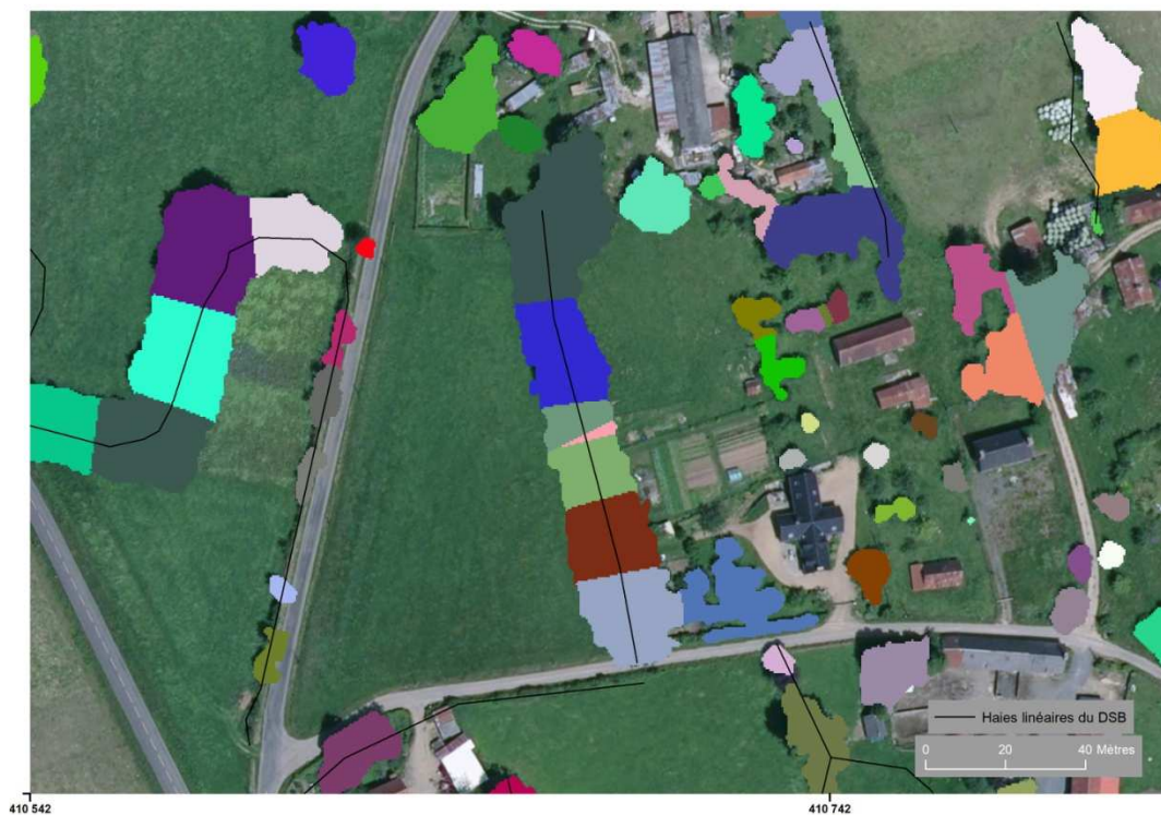
Figure 10 : exemple de résultat d'une segmentation du MNHC seuillé et filtré par un algorithme de bassin versant. Les différentes couleurs représentent des bassins versants différents
