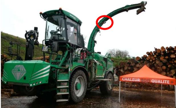
Le prototype calibré sera installé sur la **trappe de maintenance de la goulotte du broyeur** comme montré ci-dessous :
