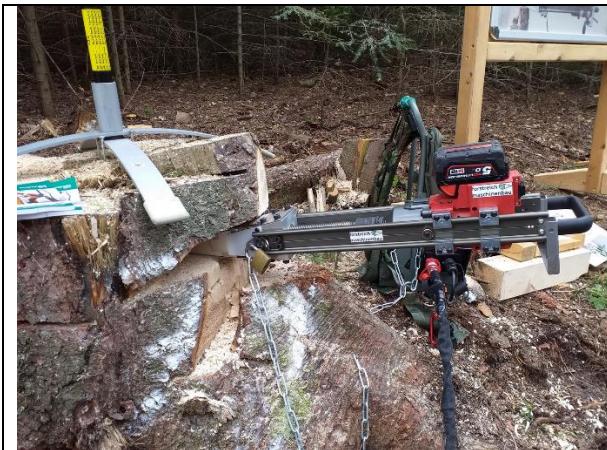
Coin télécommandé TR300 de Forsteich Actionné par un moteur électrique télécommandé à distance (portée en terrain nu de 40 m). Masse 10,2 kg avec sa batterie, force de levage 25 tonnes. Prix à partir de 2 250 € HT, plusieurs options (octobre 2022).
