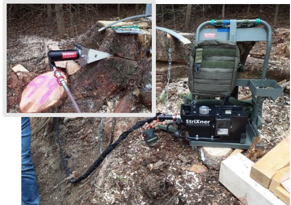
Coin télécommandé Strixner Petite pompe hydraulique installée dans un sac à dos, actionnée par un moteur électrique, reliant différents types de coins. Masse de 10 à 15 kg en fonction du coin, avec 22, 25 ou 45 tonnes de force de levage. Portée de la télécommande en terrain nu de 100 m. Prix à partir de 5 000 € HT, prix variable en fonction du coin choisi (octobre 2022)..
