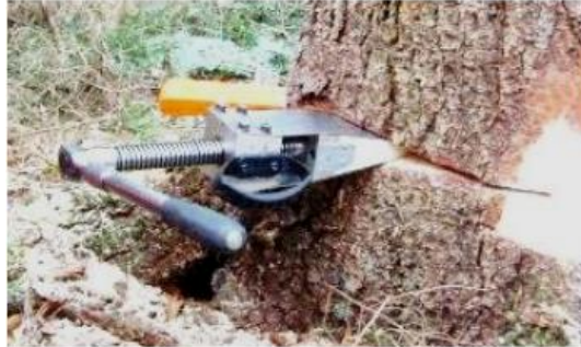
Exemple de coin mécanique actionné par un levier (source ONF) TR30, masse de 5,4 kg, force de levage 15 t, hauteur de levage 60 mm
