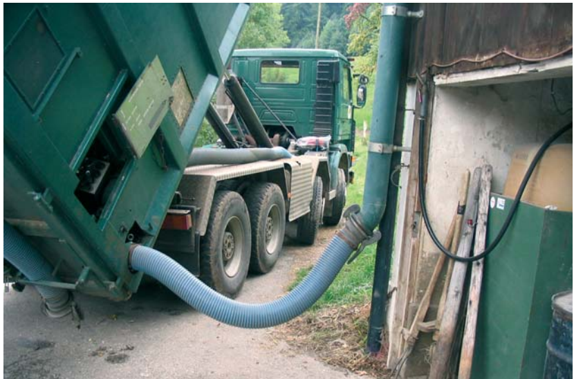
Livraison pneumatique de plaquettes (photo Biocombustibles SA).
