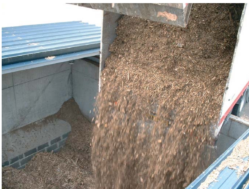
Livraison de combustible bois par benne à fond mouvant.
