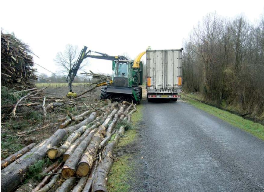
Déchiquetage en bord de route à l'aide d'une déchiqueteuse montée sur porteur forestier.
