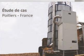
Système ReCyclone pour limiter les émissions de particules.
