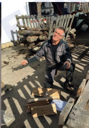
Contrôle du taux d'humidité des bûches par étuvage (à gauche) et par utilisation d'un humidimètre (à droite).
