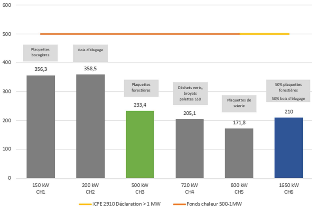
Figure 1 : Résultats des campagnes de mesures pour les CO, les particules solides (SP) et les NOx pour les six chaudières ramenés à 6 % d'O 2 .
