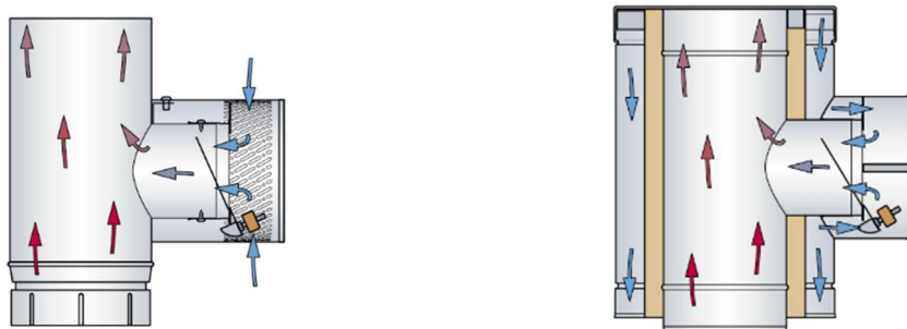
Figure 20 : Vues en coupe de régulateurs pour conduit simple paroi et concentrique [POUJOLAT].
