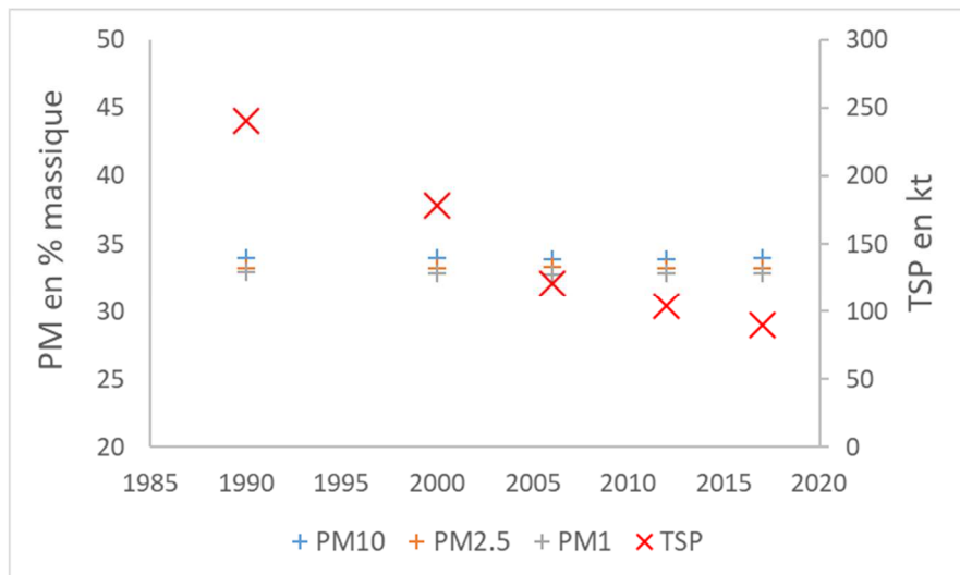
Figure 12 : Evolution des émissions de particules totales (TSP) et de la répartition granulométrique en masse des particules issues du chauffage domestique au bois, calculs basés sur les valeurs du CITEPA [9].
