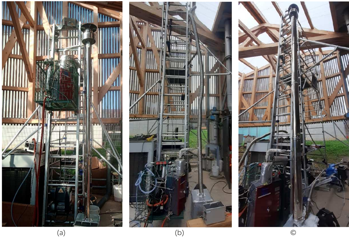
Figure 44 : Photographies des différents montages sur la plateforme : simple paroi (a), flexible (b) et concentrique (c).
