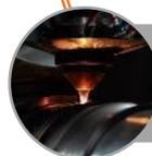
**Laser clad :** technique de fabrication avancée par dépôt d'une couche protectrice ou fonctionnelle sur un substrat à l'aide d'un faisceau laser
