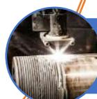
**Weld overlay :** revêtement issu du soudage pour faire fondre un matériau sur la surface d'un autre matériau différent
