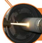
**HVOF (High Velocity Oxygen Fuel) :** pulvérisation à la flamme, utilisé pour déposer des revêtements denses, durs et résistants à l'usure, constitués de poudre
